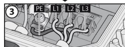
Kuva 3: Johtojen kiinnitys liittimiin
