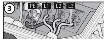
Kuva 2: Johtojen kiinnitys liittimiin
