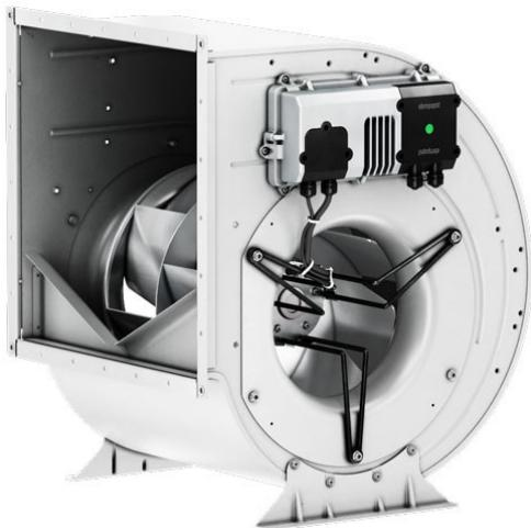
RadiFit-puhaltimessa on energiatehokas EC-moottori, jossa tehdasasennuksena käynti- ja ohjauselektronikka. Tämän ansiosta RadiFit-puhallinta voidaan säättää 0-10 V signaalilla esimerkiksi VAK:lla.
